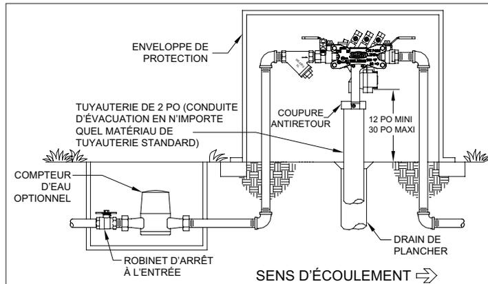
**ATTENTION :** une évacuation adéquate dimensionnée doit être prévue pour empêcher des dommages dus à l'eau refoulée par la soupape de décharge.
