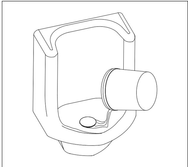
3.) Llene la trampa de aproximadamente 1 cuarto de galón de agua. Cheque las conexiones de drenaje para los escapes.
