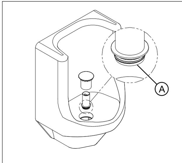
4.) Compruebe el empaque (A) en trampa de la campana. Sustituya si está necesario. Reinstale la trampa de la campana con el empaque. Apriete cómodamente con un llave de 3/8" en el sentido de las agujas del reloj. Tenga cuidado de no apretar demasiado. Instale el tamiz y rellene trampa con aproximadamente 1 cuarto de galón de agua. Compruebe a asamblea para saber si hay escapes. Agregue 4 onzas de sellante Zurn *AquaGreen*™ a la trampa.
