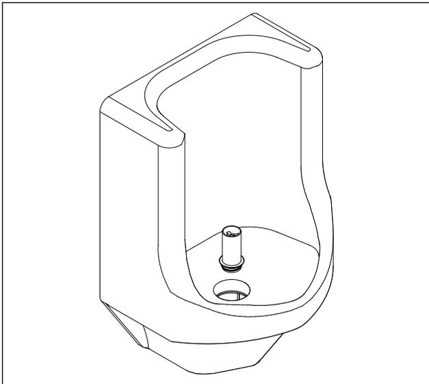
1.) Inserte la trampa de la campana con el empaque (numero 3) en orinal y apriete en el sentido de las agujas del reloj. No apriete demasiado.
