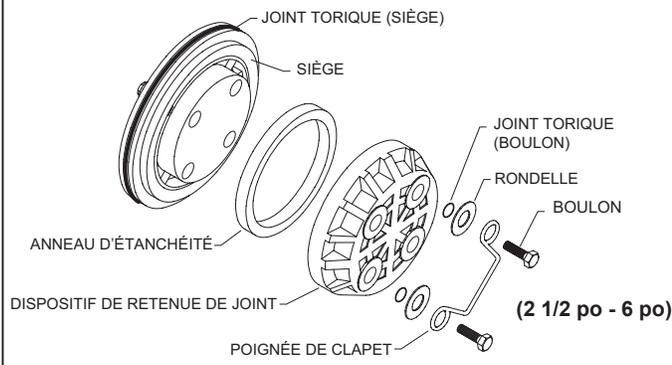
Les dispositifs antirefoulement modèles 375AST doivent être inspectés et entretenus par un personnel détenteur d'une licence au moins une fois par an ou plus souvent si les codes locaux le prescrivent. Remplacer les pièces usées ou endommagées uniquement par des pièces « ZURN WILKINS » d'origine.
